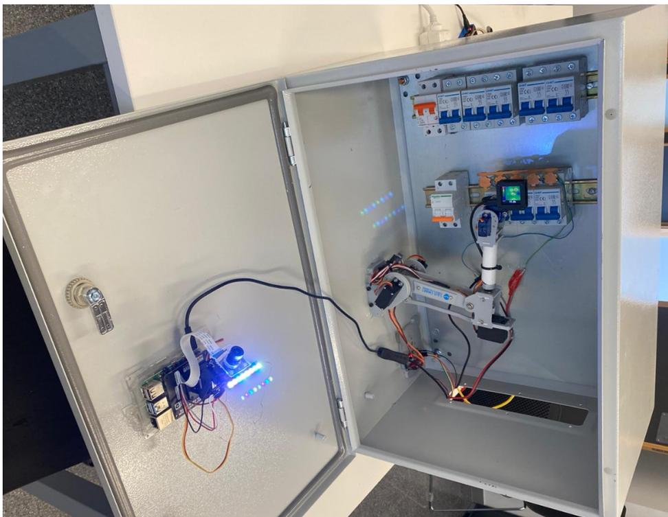
El referido prototipo de inspección remota de un cuadro eléctrico supuso un primer paso para profundizar en la digitalización y actuación en remoto de las actividades de mantenimiento y que es además extrapolable y aplicable a otros tipos de instalaciones de seguridad industrial.
